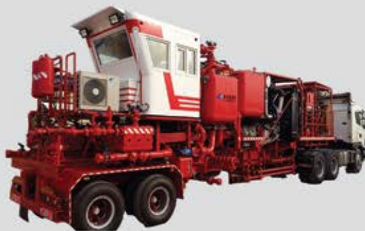
ساخت تربلر سیمان کاری و اسیدزنی (شرکت ملی مناطق نفت خیز جنوب)
