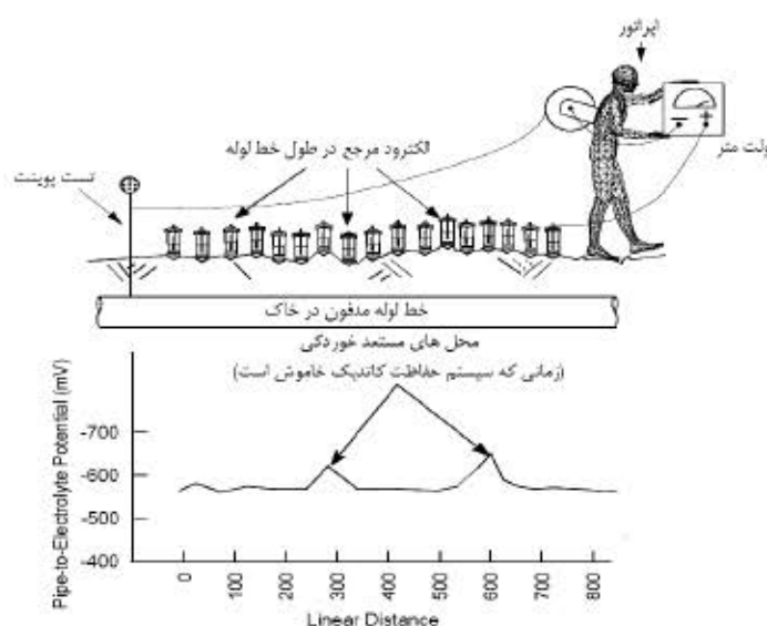
طرح شماتیک تهیه پروفایل پتانسیل خط لوله
