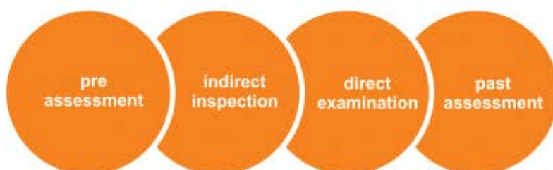
روند بررسی پوشش خطوط لوله مدفون
