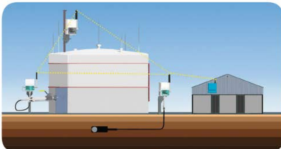
بهره گیری از پروب های ER در پایش نرخ خوردگی کف مخازن
