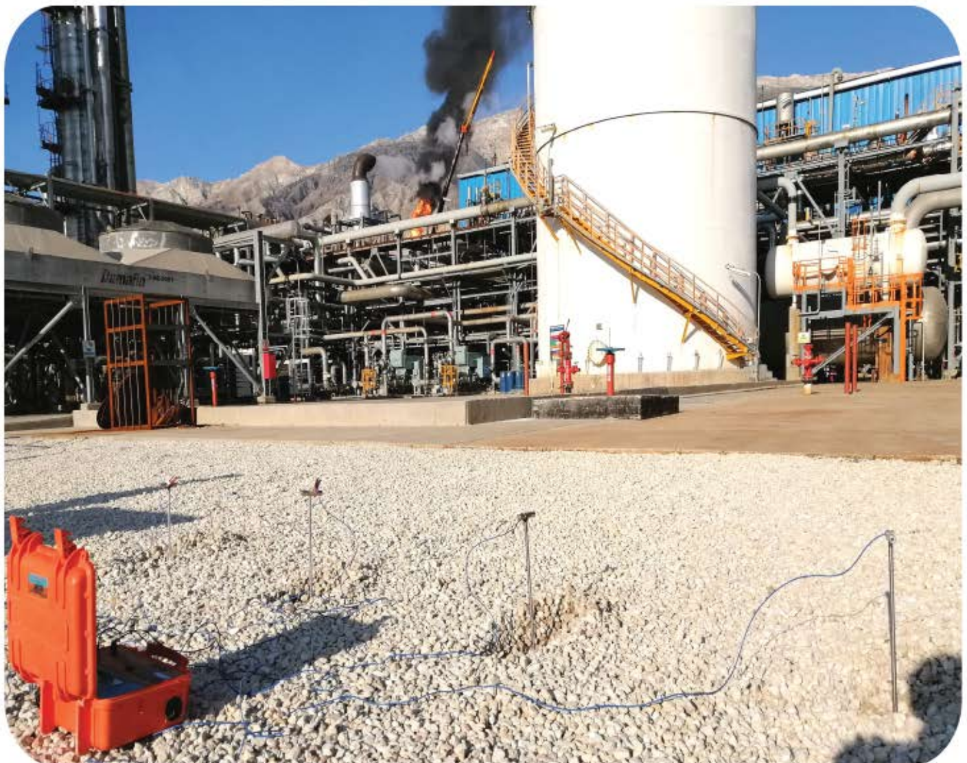
اندازه گیری مقاومت خاک به روش ۴ پین و نر
